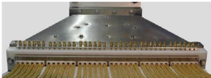
Boca de extrusión horizontal de 36 sogas para galletitas con inclusión de trocitos de nueces
