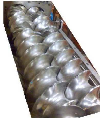
Tornillos de mezclado y amasado autolimpiantes
