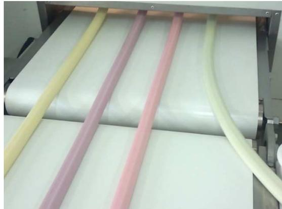
Estas sogas son llevadas por corto tiempo a través de un túnel de acondicionamiento y de ahí pueden ser dirigidas directamente a las máquinas que siguen, por ejemplo a equipos de rolado tipo calandra si se quiere elaborar esferas o productos similares, o también a envolvedoras tipo cut & wrap para producir en tiras o en trocitos de variada forma.
